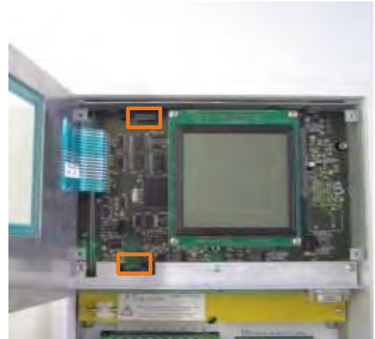
Откройте переднюю панель и найдите два соединителя (обозначенные оранжевыми прямоугольниками).
